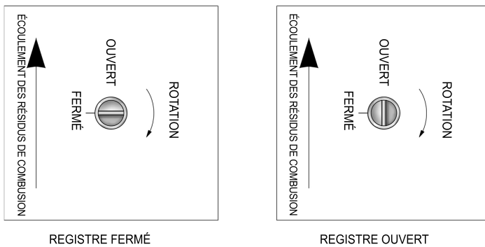
Figure 8-3 – Indicateur de position du registre d'évent
